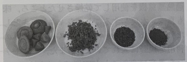
左から、原体→ダイサーにかけたもの→過熱蒸煎機で乾燥させたもの→粉体加工したもの
